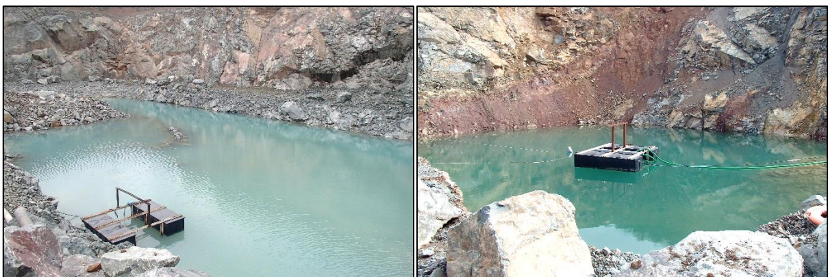
Les bassins de décantation des eaux de procédé
